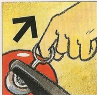
La mise en service d'un extincteur est simple : retirez le dispositif de sécurité (goupille ou autre), percutez si nécessaire, agissez sur la poignée pour libérer le produit extincteur.
